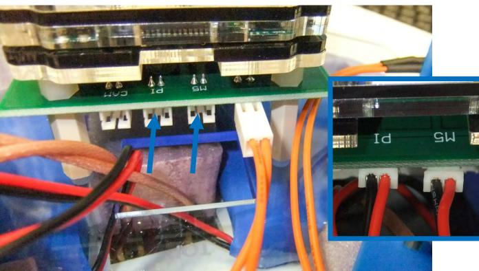
BEFORE PLUGGING IN BATTERIES MAKE SURE THE KEY SWITCH IS IN THE OFF POSITION AND PLUGGED INTO THE POWER BOARD!
